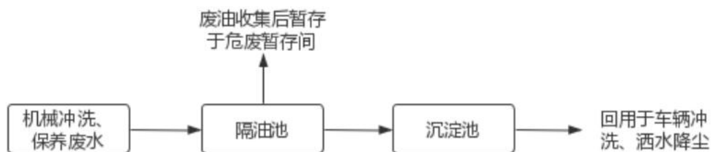
图 7.1-2 车辆冲洗、机修废水处理工艺流程图
