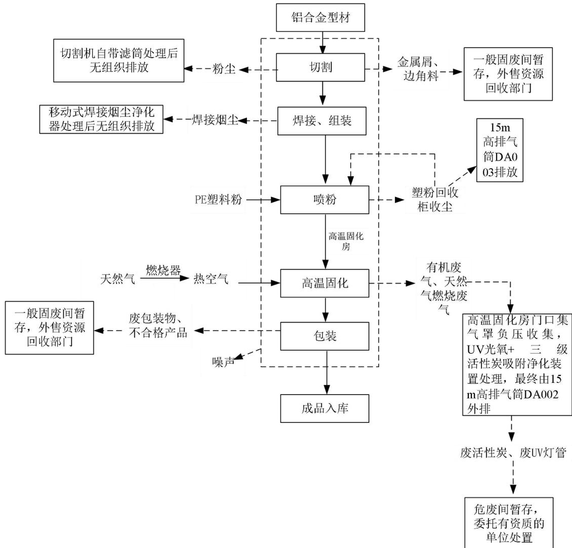
图 2-5 铝合金花箱护栏生产工艺及产污节点图
