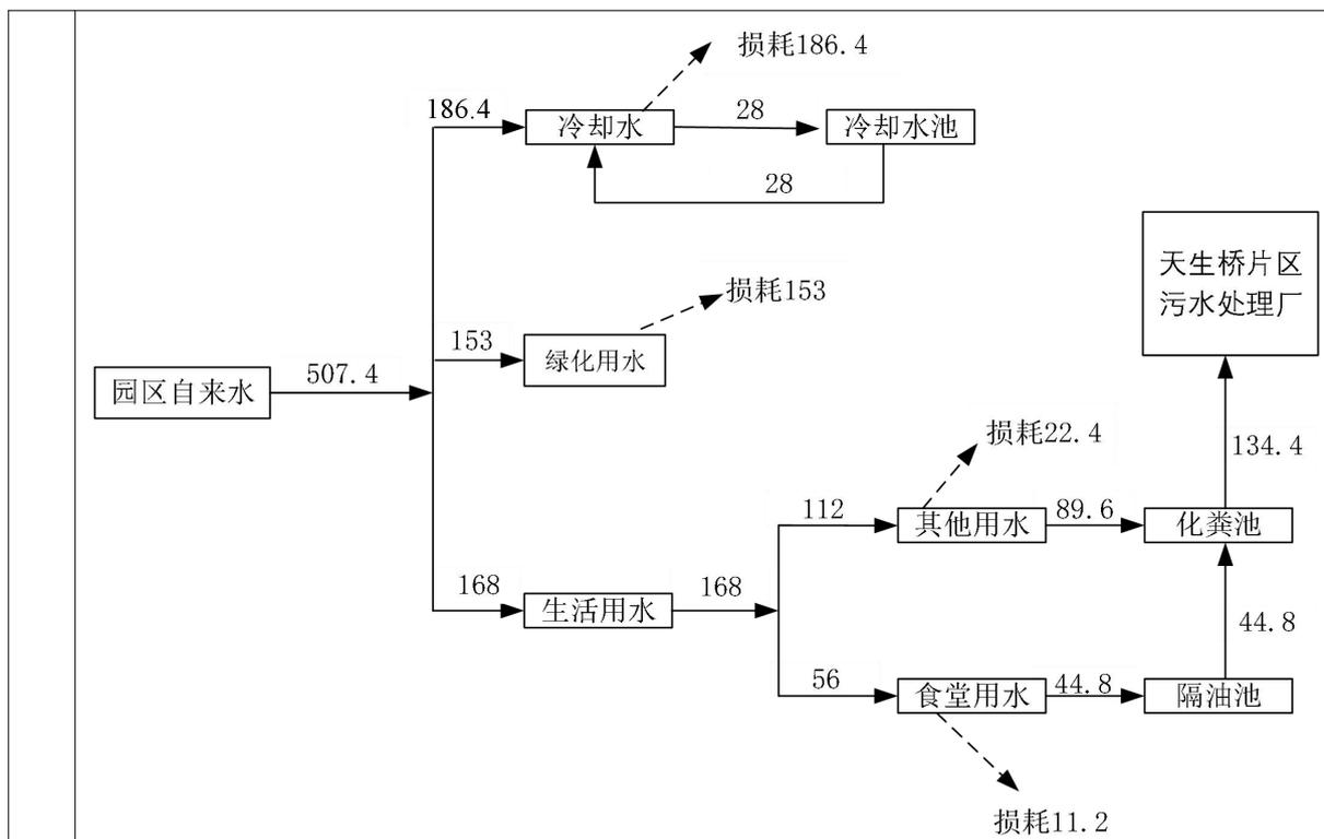
图 2-2 项目远期水量平衡图 (m³/a)
