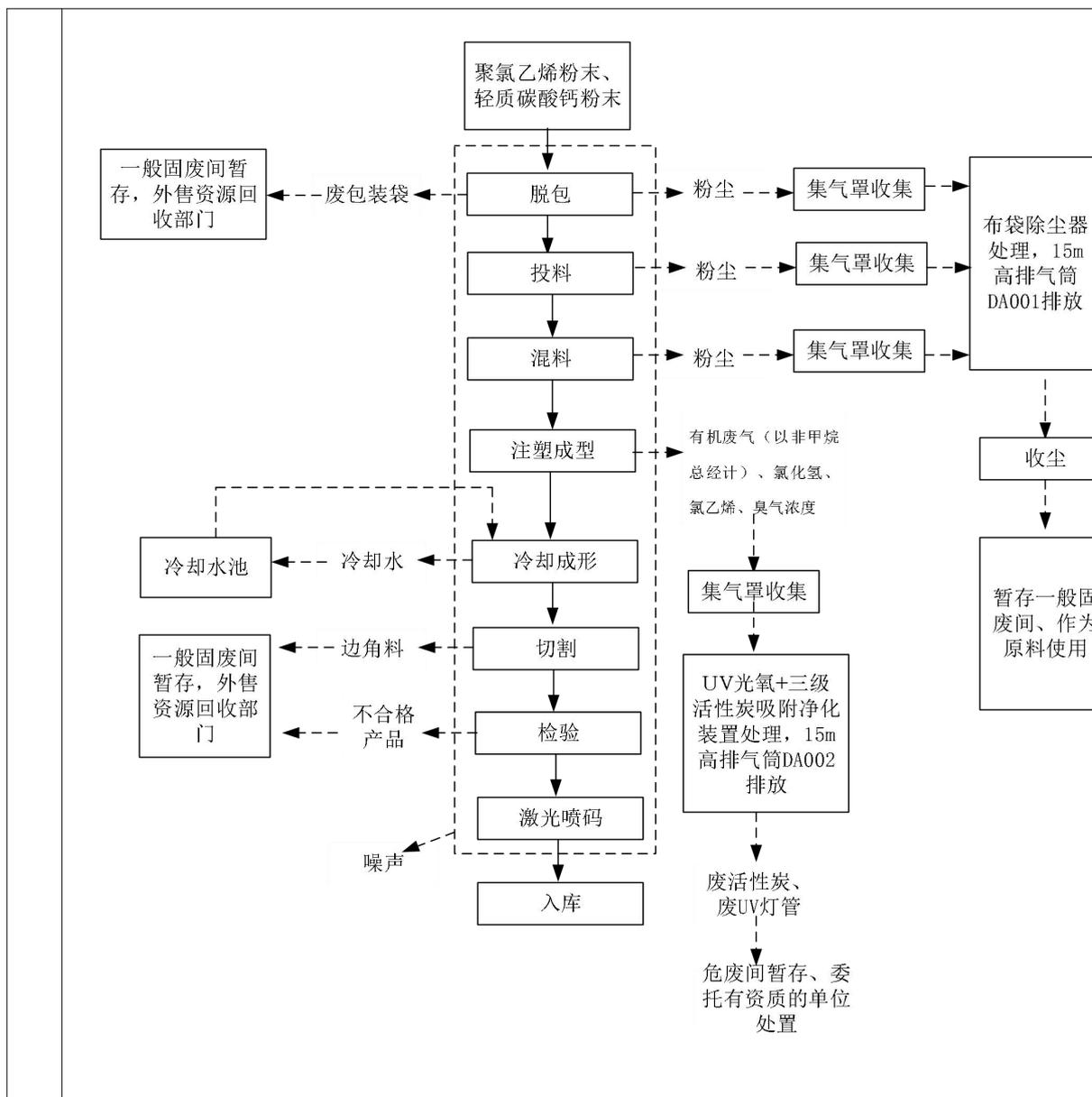
图 2-7 PVC 管材管件生产工艺及产污节点图
