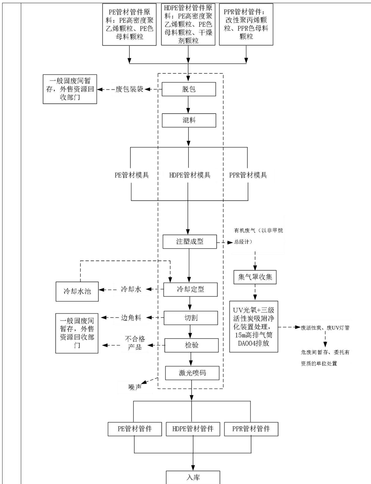
图 2-8 PE、HDPE、PPR 管材管件生产工艺及产污环节
