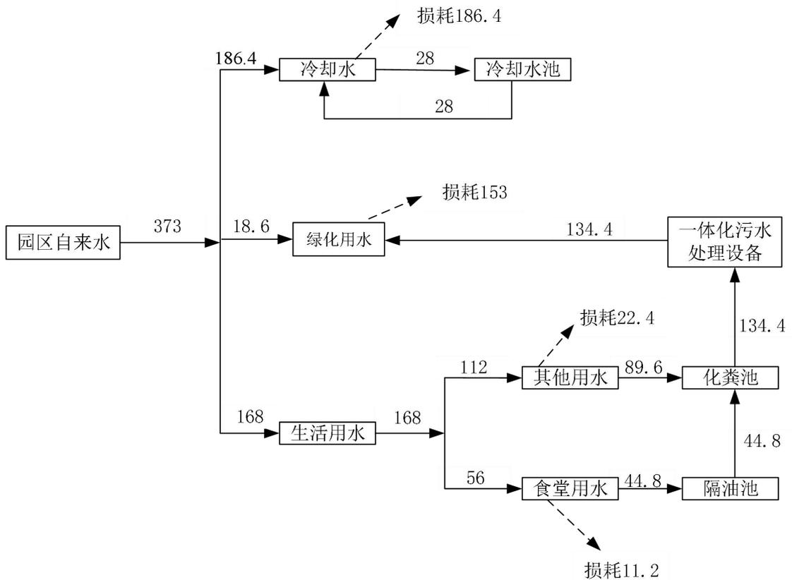
图 2-1 项目近期水量平衡图 (m³/a)
