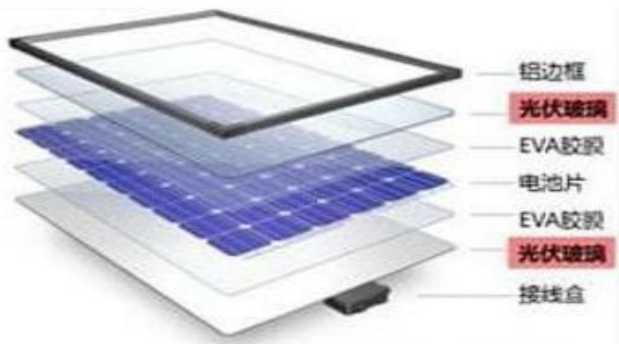
图 2-2 双玻光伏板结构图
